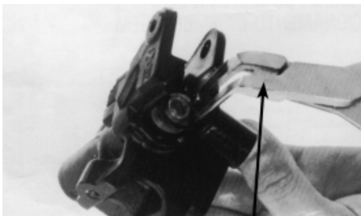
ALICATE PARA ANEL ELÁSTICO (07914-3230001)
